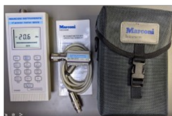
Marconi 6970 RF Power Meter
